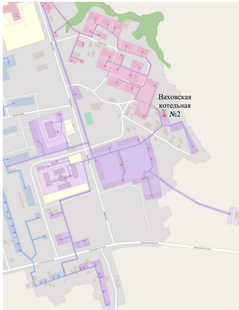
Рисунок 6 – План тепловых сетей Ваховской котельной № 2
